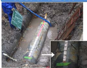
パイプラインの破壊による漏水
